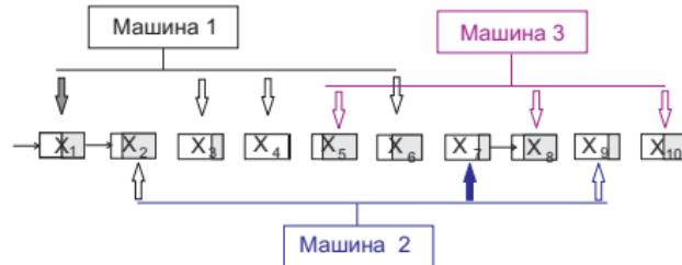
$$\begin{array}{lllll} \dot{x}_1 = v - v_1 & \dot{x}_2 = v_1 & \dot{x}_3 = 0 & \dot{x}_4 = 0 & \dot{x}_5 = 0 \\ \dot{x}_6 = 0 & \dot{x}_7 = -v_7 & \dot{x}_8 = v_7 & \dot{x}_9 = 0 & \dot{x}_{10} = 0 \end{array}$$
