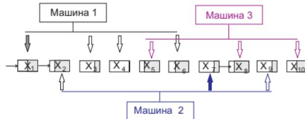
$$\begin{array}{lllll} \dot{x}_1 = v - v_1 & \dot{x}_2 = v_1 & \dot{x}_3 = 0 & \dot{x}_4 = 0 & \dot{x}_5 = -v_5 \\ \dot{x}_6 = v_5 & \dot{x}_7 = -v_7 & \dot{x}_8 = v_7 & \dot{x}_9 = 0 & \dot{x}_{10} = 0 \end{array}$$
