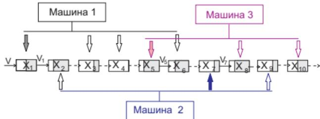
$$\begin{aligned}\dot{x}_1 &= v - v_1 & \dot{x}_2 &= v_1 & \dot{x}_3 &= 0 & \dot{x}_4 &= 0 & \dot{x}_5 &= -v_5 \\ \dot{x}_6 &= v_5 & \dot{x}_7 &= -v_7 & \dot{x}_8 &= v_7 & \dot{x}_9 &= 0 & \dot{x}_{10} &= 0\end{aligned}$$
