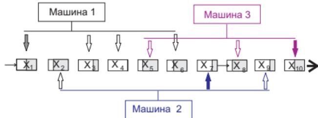
$$\begin{aligned}\dot{x}_1 &= v - v_1 & \dot{x}_2 &= v_1 & \dot{x}_3 &= 0 & \dot{x}_4 &= 0 & \dot{x}_5 &= 0 \\ \dot{x}_6 &= 0 & \dot{x}_7 &= -v_7 & \dot{x}_8 &= v_7 & \dot{x}_9 &= 0 & \dot{x}_{10} &= -v_{10}\end{aligned}$$
