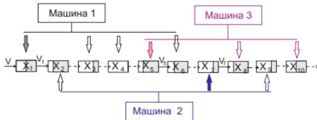
$$\begin{aligned}\dot{x}_1 &= v - v_1 & \dot{x}_2 &= v_1 & \dot{x}_3 &= 0 & \dot{x}_4 &= 0 & \dot{x}_5 &= -v_5 \\ \dot{x}_6 &= v_5 & \dot{x}_7 &= -v_7 & \dot{x}_8 &= v_7 & \dot{x}_9 &= 0 & \dot{x}_{10} &= 0\end{aligned}$$
